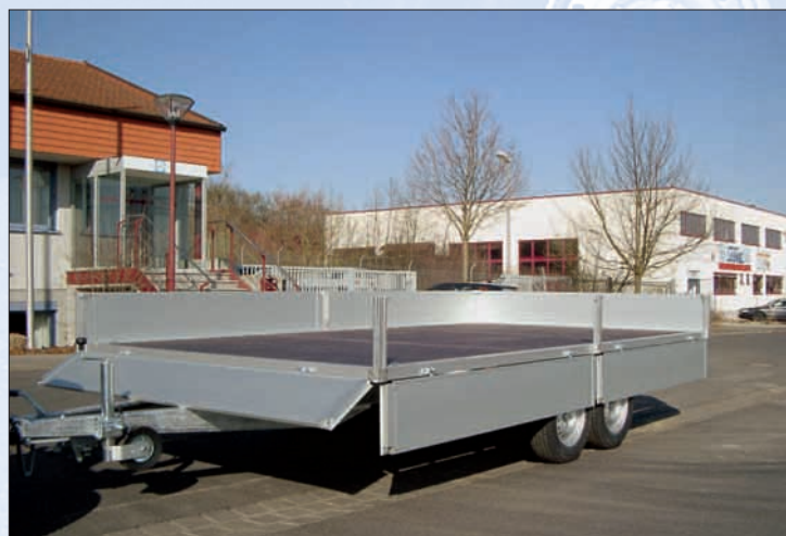
HLN und HLC Hochlader mit Aluauffahrschienen (Tragkraft: ca. 2500 kg) / HLN et HLC remorques-plateau avec rampes en alu (PTAC des rampes: 2500 kg environ) / HLN and HLC highriders with aluminium loading ramps (carrying capacity: about 2500 kg)
