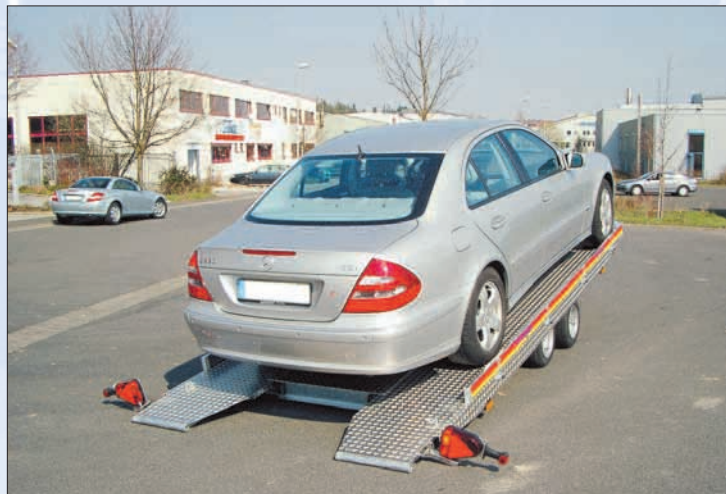
KHL 3000 Hy.k Maximaler Radstand des transportierten Fahrzeugs: 2,85 m / distance maximum entre les roues du véhicule transporté: 2,85 m / maximum distance between wheels of transported vehicle: 2.85 m
