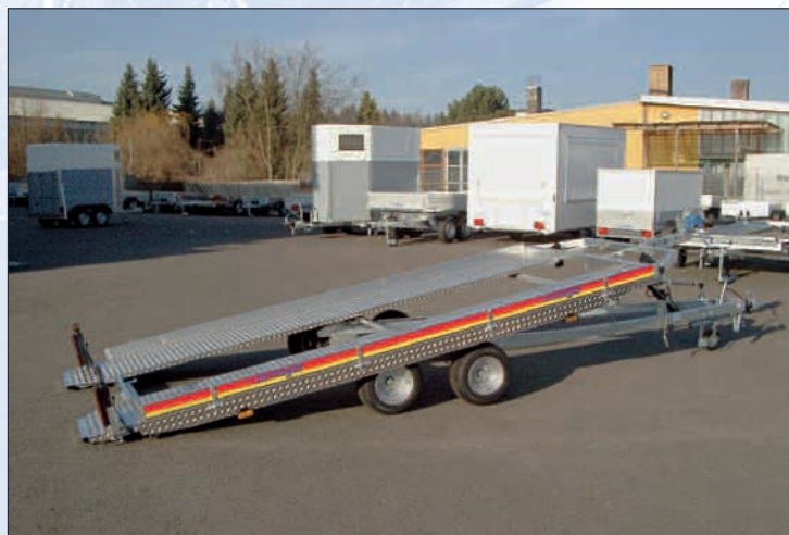
Offener Boden mit 2 Alustandschienen (Serie) / plancher ouvert avec 2 rampes en alu (en série) / open platform with 2 aluminium ramps (standard feature)
