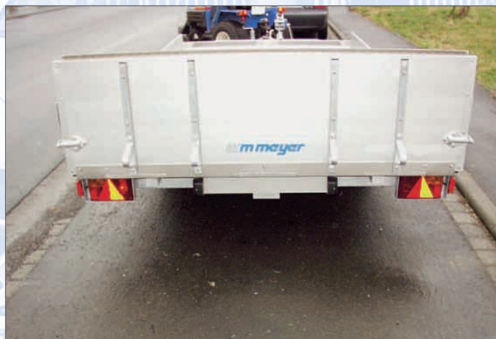
Auffahrrampe (Alu) inkl. V2A-Scharnier (Höhe: ca. 600 mm, Serie) / rampe en alu avec des charnières en inox (hauteur: 600 mm environ, en série) / loading ramp (aluminium) with high-grade steel hinges (height: about 600 mm, standard feature)
