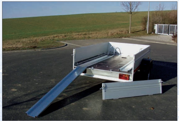
Alubordwanderhöhung (auf Bordwände aufgesetzt) / ridelles additionnelles en alu (sur ridelles standard) / increase in panel height, aluminium (on standard side panels)
