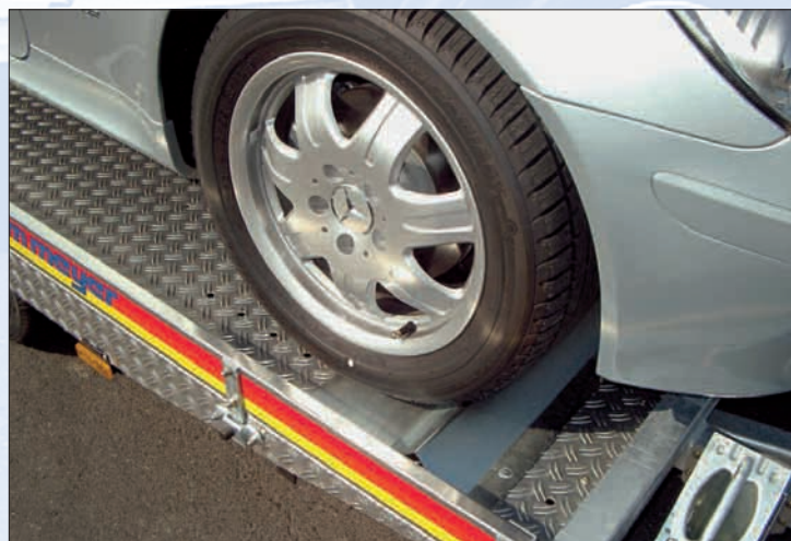
2 verstellbare Anfahrkeile (Aufpreis) / 2 supports de roues réglables (en option) / 2 wheel supports (optional extra)
