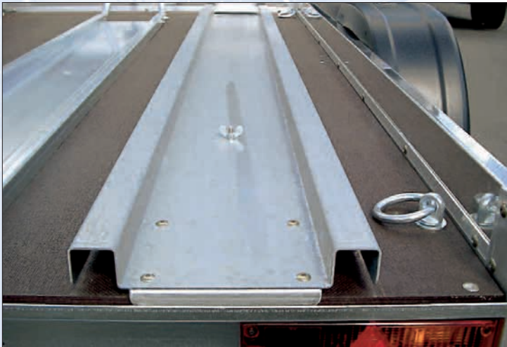
Auffahrschienen mit Schraube arretiert / rampe vissée au plancher / loading ramp screwed to platform
