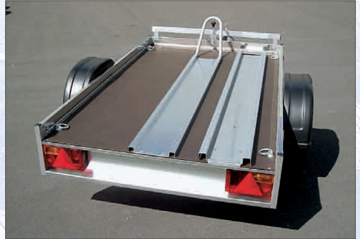
Siebdruckboden, Alubordwände (Serie) / plancher de bois antidérapant imperméabilisé, ridelles en alu (en série) / high-density plywood platform, aluminium side panels (standard feature)
