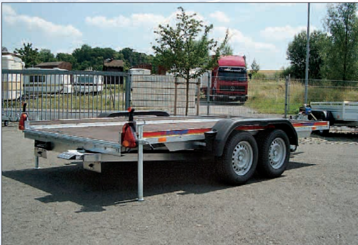
AP 2040/200 Siebdruckboden, Alubordwände (Serie) / plancher de bois antidérapant imperméabilisé, ridelles en alu (en série) / high-density plywood platform, aluminium side panels (standard feature)
