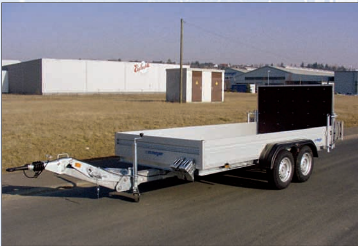
Zubehör: höhenverstellbare Deichsel, Sonderausstattung: Holzrampe / accessoire: timon réglable, équipement spécial: rampe en bois / optional extra: drawbar adjustable in height, special equipment: wooden ramp
