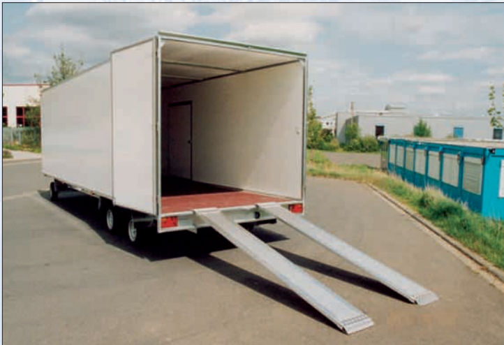
DSH Drehschemelanhänger mit Aluauffahrschienen (Tragkraft: ca. 2500 kg) / DSH remorques à essieu avant directionnel avec rampes en alu (PTAC des rampes: 2500 kg environ) / DSH drawbar trailers with aluminium loading ramps (carrying capacity: about 2500 kg)
