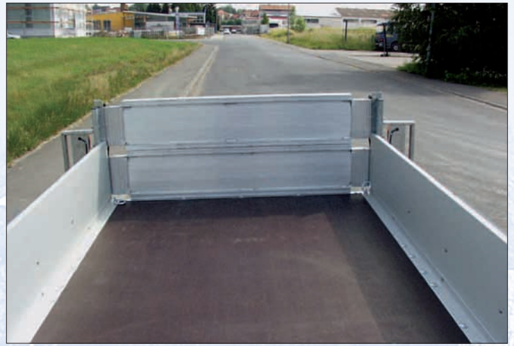
Auf Wunsch Auffahrschienen quer (ohne Aufpreis) / rampes en position horizontale comme ridelle arrière (pas de supplément) / loading ramps stored horizontally and serving as rear panel (no extra charge)
