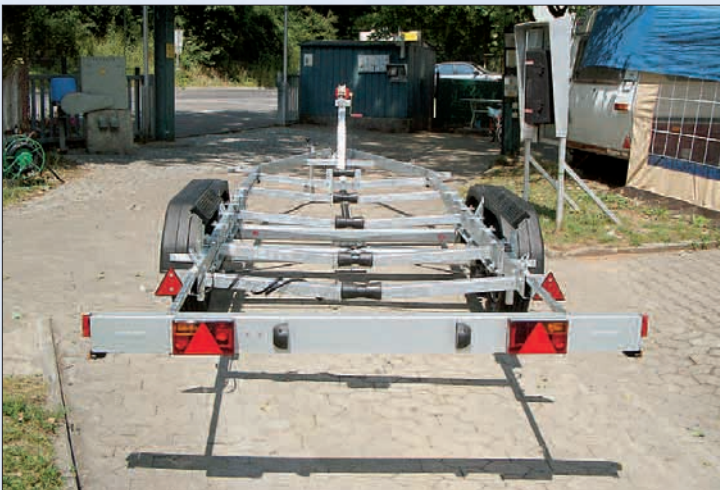
Ausziehbare Aluleuchtenleiste, gekröpfte Traversen / traverse d'éclairage amovible (en aluminium), traverses en V / removable rear lights support (aluminium), V-shaped crossbars
