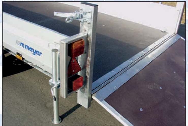
Heckstützen und Eckpfosten in Stahl verzinkt, Leuchtenträger und Rampenscharnier in Edelstahl / béquilles et coins arrière en acier galvanisé, support d'éclairage et charnière de rampe en inox / prop stands and rear corner posts galvanised steel, lights support and ramp hinge high-grade steel
