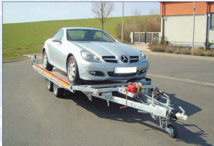
Windenbock und 1-Gang-Seilwinde (Serie) / support de treuil et treuil (en série) / winch support and one-gear winch (standard feature)
