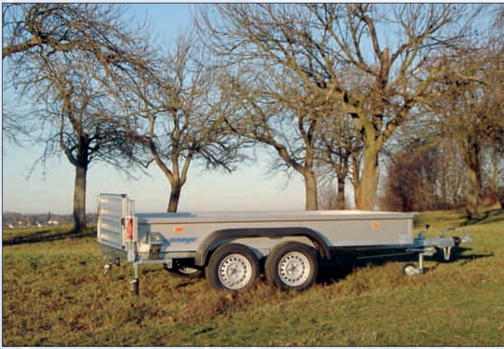
Auf Wunsch Auffahrschienen quer (ohne Aufpreis) / rampes en position horizontale comme ridelle arrière (pas de supplément) / loading ramps stored horizontally and serving as rear panel (no extra charge)
