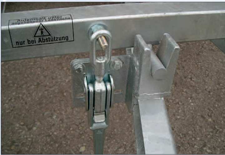
Sicherheitsverschlüsse zur Arretierung der Plattform (Serie) / fermetures à sécurité attachées à la plateforme (en série) / platform security locks (standard feature)
