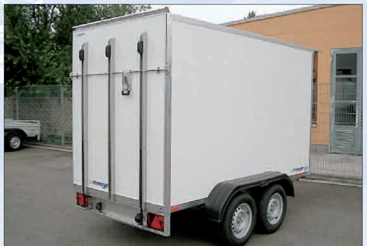
AZ Koffernhänger mit Heckrampe (Tragkraft: ca. 900 kg) / AZ fourgons avec rampe (PTAC de la rampe: 900 kg environ) / AZ box vans with ramp (carrying capacity: about 900 kg)
