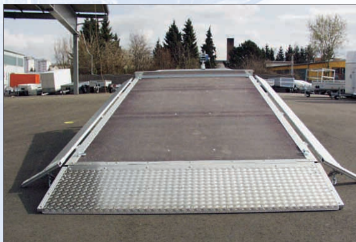
Auffahrwinkel je nach Bereifung: ca. 8°-10° / angle d'inclinaison: entre 8° et 10° (dépend des pneus) / tipping angle: 8°-10° (depending on tyres)
