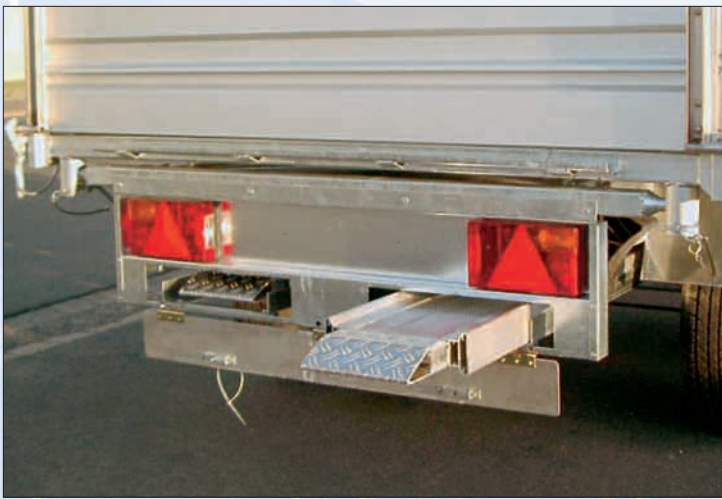
HKC und HKCR Dreiseiten- und Rückwärtstipper (Hochlader) mit Aluauffahrschienen (Tragkraft: ca. 2500 kg) / HKC et HKCR bennes et tri-bennes (remorques-plateau) avec rampes en alu (PTAC des rampes: 2500 kg environ) / HKC and HKCR tippers and rear tippers (highriders) with aluminium loading ramps (carrying capacity: about 2500 kg)
