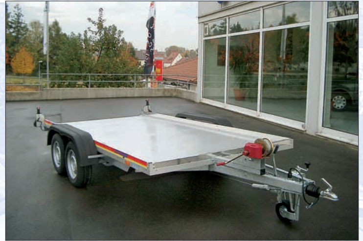
AP 2040/200 Aluprofilboden (Aufpreis), Alubordwände (Serie) / plancher en alu (en option), ridelles en alu (en série) / aluminium platform (optional extra), aluminium side panels (standard feature)
