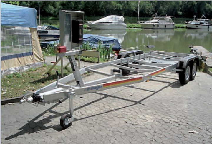
BO 3565/160 T Geschweißter V-Rahmen (Stahl verzinkt), Windenbock und 1-Gang-Seilwinde (Serie), Positionsleuchten vorne (nicht in Deutschland) / châssis en V en acier galvanisé (soudé), support de treuil et treuil (en série), feux de position avant (pas en Allemagne) / welded, galvanised V chassis, winch support and one-gear winch (standard feature), front position lights (not in Germany)
