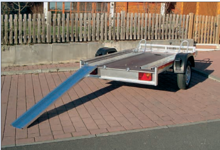
Auffahr- und Standschienen abnehmbar, dank geschlossenem Boden Anhänger auch für andere Transportzwecke verwendbar / rampe et rails de chargement démontables, grâce au plancher fermé remorque aussi idéale pour transporter d'autres choses / removable loading ramp and motorcycle stands, thanks to the closed platform the trailer can be used as a multi-purpose transporter
